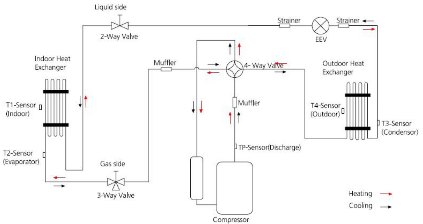
Pour les modèles 9kW et 12kW, le Muffler se situe uniquement du côté basse pression.
