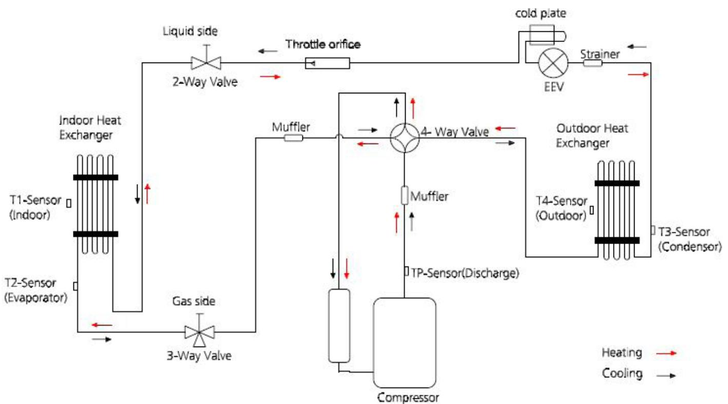
Pour le modèle 30kW, le Muffler se situe uniquement sur le tuyau d'évacuation.
